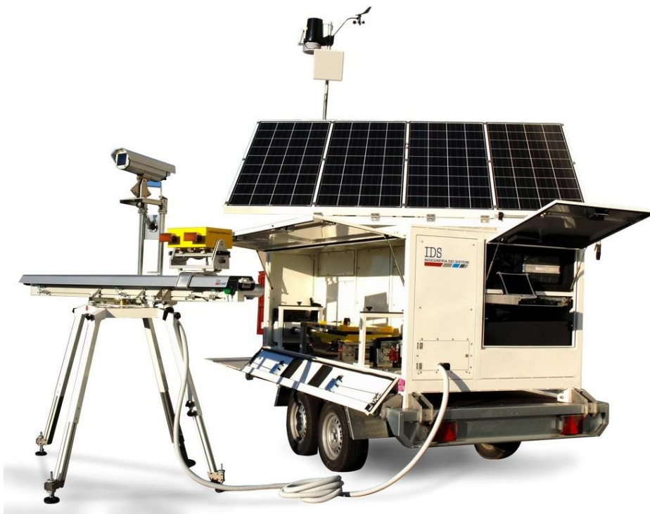
Рис. 3. Радарна система IBIS-FMT
