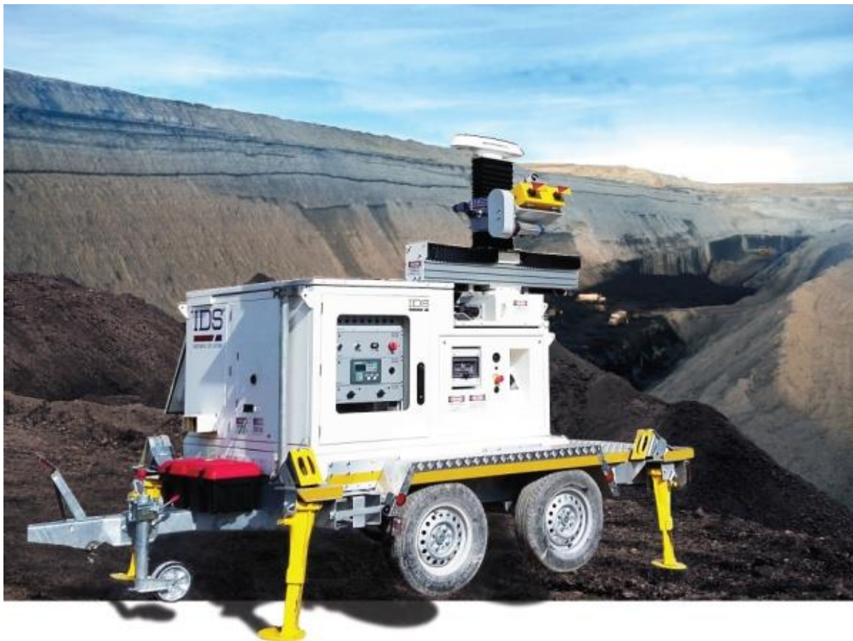
Рис. 4. Радарна система IBIS-ROVER
